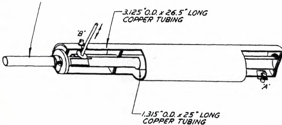
FIGURE 2.1. TEST CAVITY CONSTRUCTION
