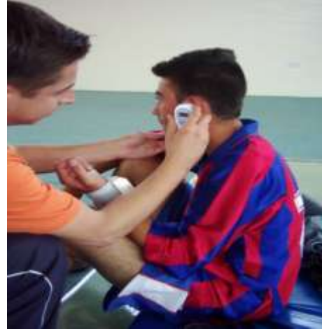
Şekil 2. Gentle Temp 510 Omron Dijital Kulak Zarı Termometresi ve Ölçüm Esnasında Kullanışı.
