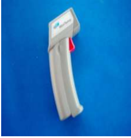
Şekil 1. Mini Temp 0-0344 Lazer Termometre ve Ölçüm Esnasındaki Kullanışı.
