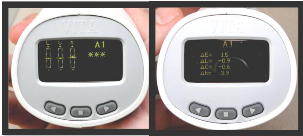
Şekil 3.17. Ölçüm sonucunun başarısının yıldızlarla ifade edilmesi ve \Delta E değerinin belirlenmesi.
