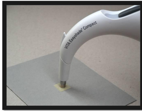
Şekil 3.10. Nötral gri arka plan üzerinde renk ölçümlerinin yapılması.
