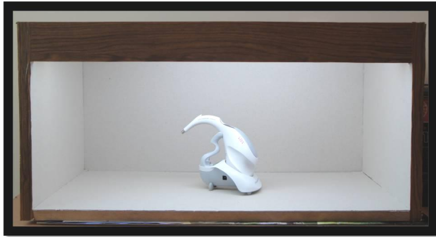
Şekil 3.9. Renk ölçüm kutusu ve VITA Easyshade Compact.
