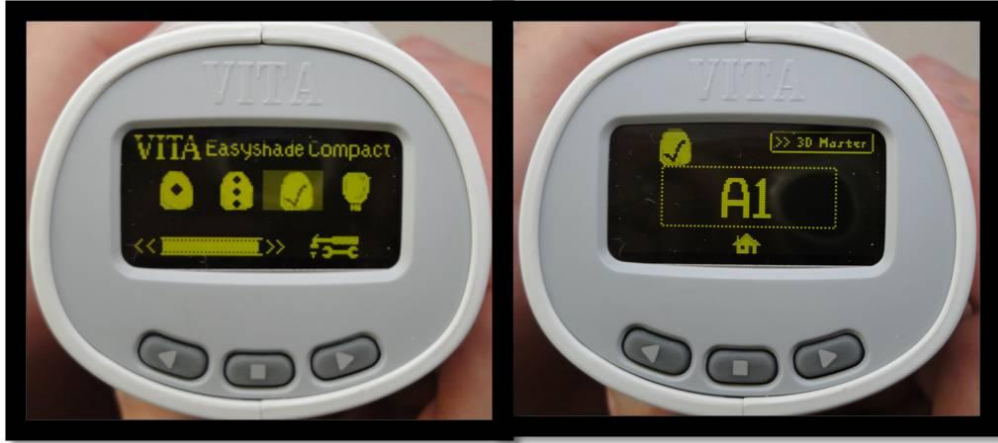
Şekil 3.16. Spektrofotometrenin restorasyon ölçüm modunun seçilmesi ve kıyaslanmak istenen rengin Vitapan Classical skalasına göre kodunun girilmesi.
