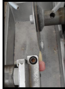
Şekil 8. Düşük hızlı testere ile kesme işleminin görüntüsü
