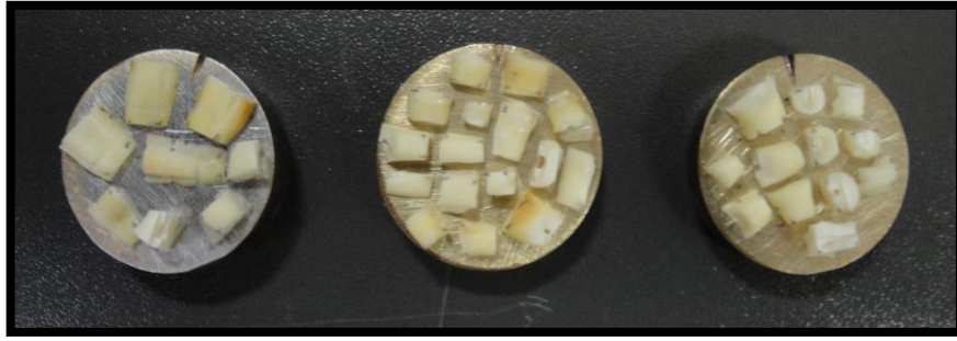
Şekil 9. Dehidratasyon işlemi sonrasında alüminyum bloklar üzerine yerleştirilen örnekler
