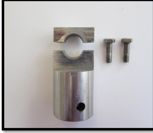
Şekil 3.6. Üniversal test cihazı için hazırlanmış metal çene.
