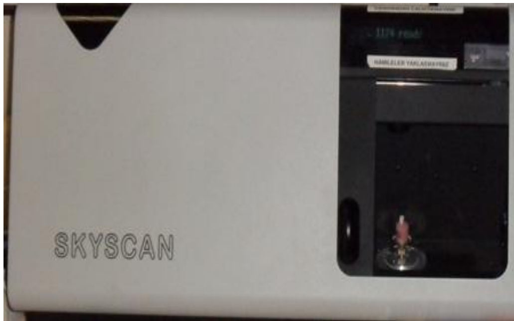
Şekil 3.8: Skyscan MBT cihazına yerleştirilmiş diş örneği
