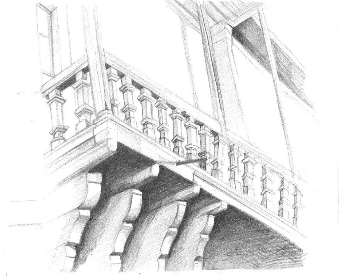
Şekil 5. 127 Çorakçılar Konağı'nın güney cephesinde bulunan taş destekler üzerine oturan dışa çıkmalı balkon (Bediha Uğur).
