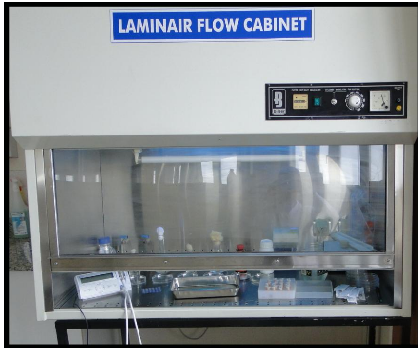
Şekil 3.5. Örneklerin kemomekanik preparasyon işlemlerinin gerçekleştirildiği “Laminar flow cabinet”in görüntüsü.
