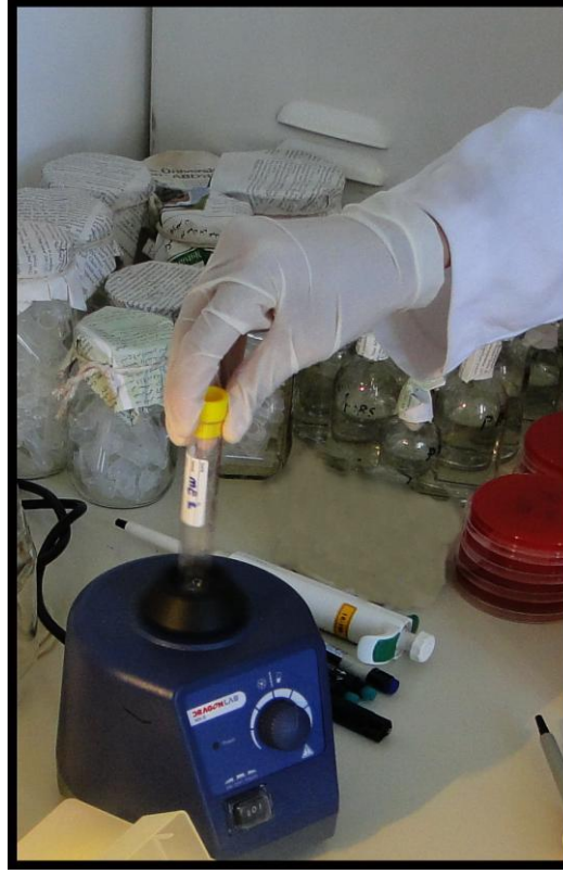
Şekil 3.4. Bakteri süspansiyonunun vorteks cihazında titreşime tabi tutulması.
