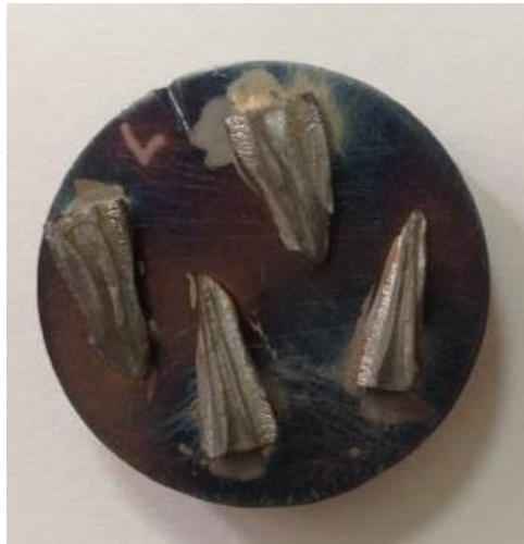
Şekil 3.10. SEM incelemesi için platin kaplanmış örnekler.
