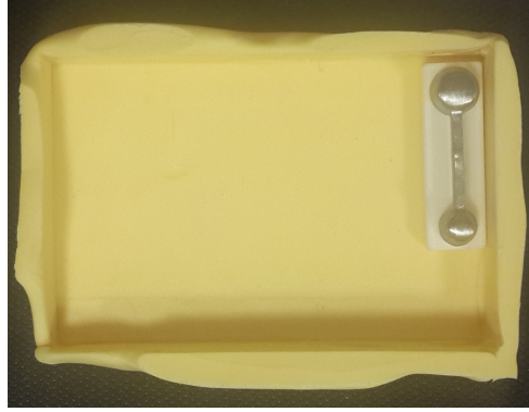
Şekil 3.9 Simante edilmiş metal alt yapının silikon kalıp içerisinde konumlandırılması
