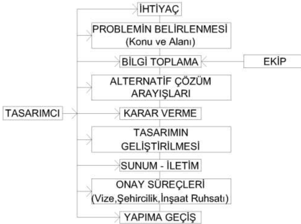
Şekil 5.2: Tasarlama sürecinin başlangıç ve bitiş noktası
