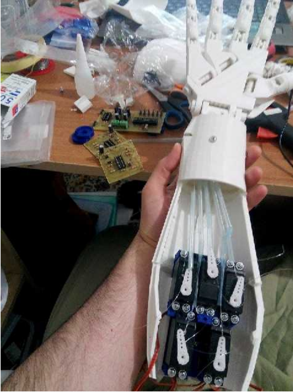
Resim-7: Protez kolumuzun ierisine yerle tirdi imiz servo motorların grnts
