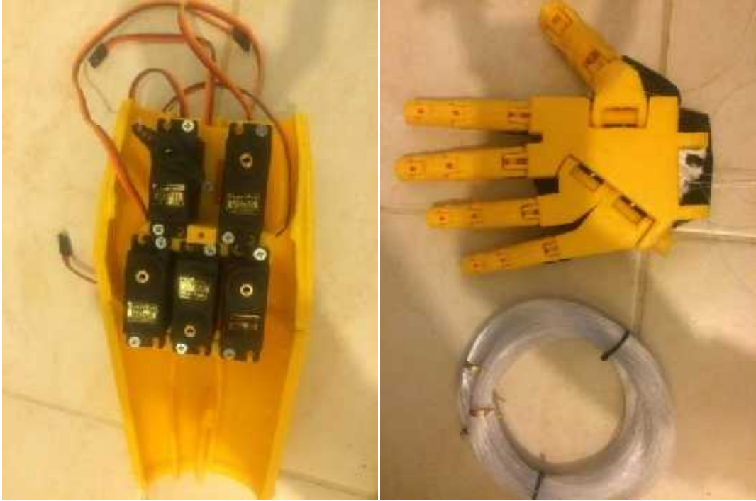
Figür 10: Servo ve 3b el entegrasyonu
