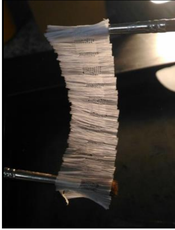
Şekil 3.9.1: Kesit Alınmış PLA Bazlı Yapı iskelesi
