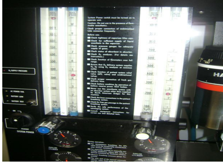
Şekil 8 :Anestezi cihazı üzerinde flowmetre ve düğmeleri (ERBAY Rıza Hakan, Anesteziyoloji, 2006)
