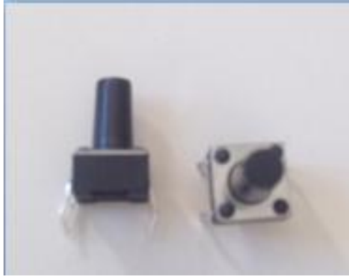
Resim 13: Cihazda kullanılan buton türü
