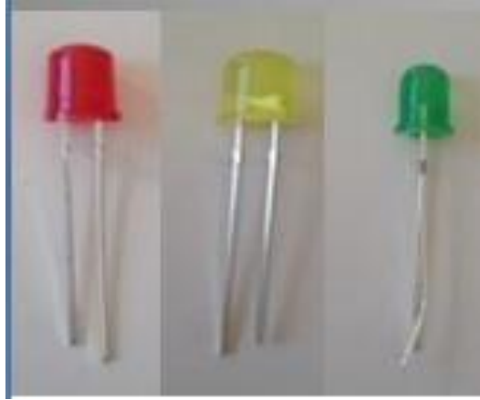
Resim 8: Cihazda kullanılan LED türleri
