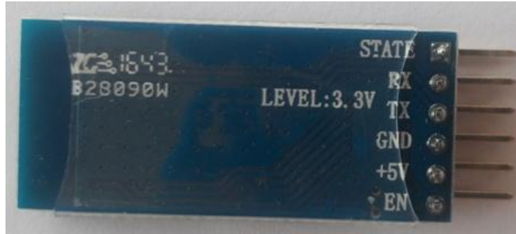
Resim 9: Cihazda kullanılan Bluetooth modülü
