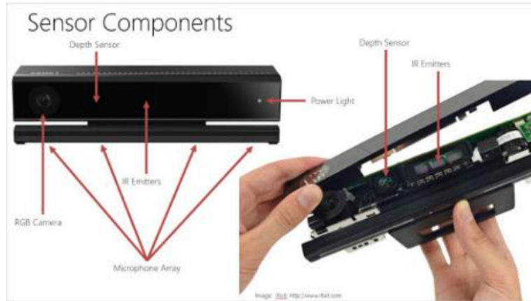
Görüntü 35: Microsoft Kinect aygıtı bileşenleri, soldan sağa; RGB Kamera, derinlik sensörü, yayıcılar, dört mikrofon bölümü, güç ışığı. ( https://i2.wp.com/infraready.co.uk/wp-content/uploads/2018/03/KINECT-V2-FOR-WINDOWS-SENSORS.png?fit=640%2C361&ssl=1 )
