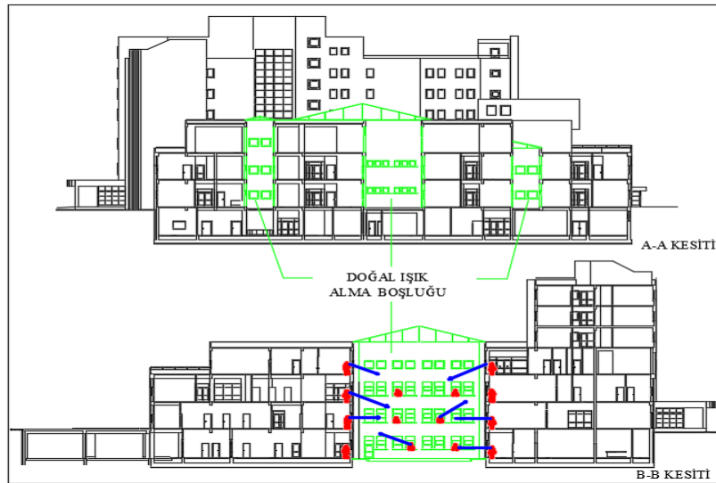
Şekil 4.92: Hastanede bulunan iç avlu havalandırma ve doğal aydınlatma boşlukları
