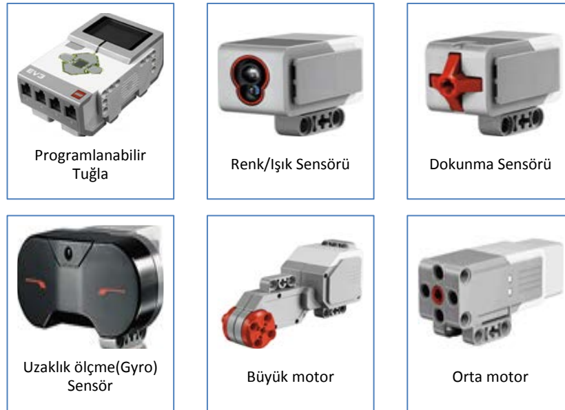
Şekil 4. Lego Mindstorms EV3 setinde bulunan parçalar
