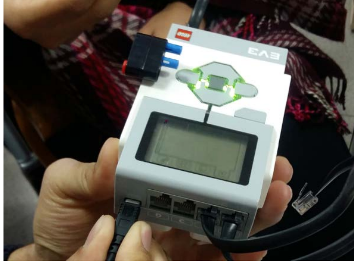
Şekil 8. Lego programlanabilir tuğlası üzerindeki motor giriş birimleri
