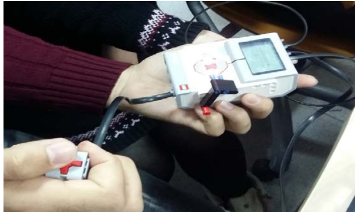
Şekil 19. Dokunma Sensörünün programlanabilir tuğlaya takılması
