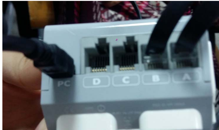
Şekil 9. Lego programlanabilir tuğlası ve bilgisayar bağlantısı
