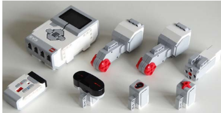
Şekil 7. Lego programlanabilir tuğlası, sensör ve motor giriş
