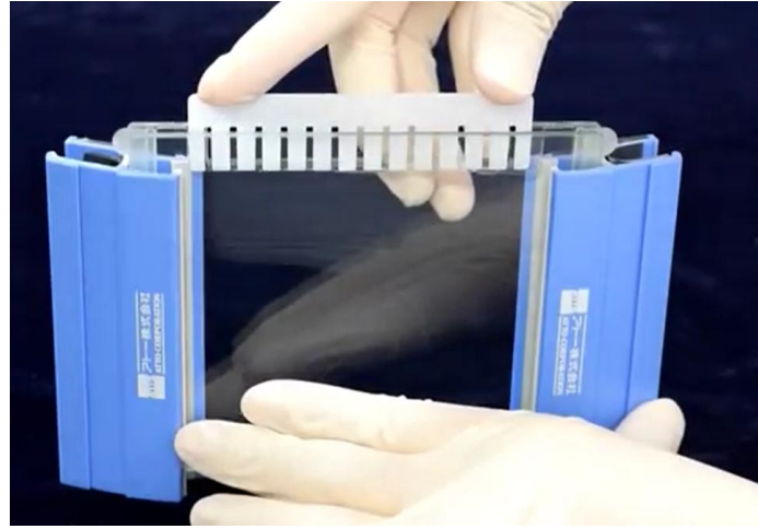
Şekil 2.5: Klipslerle tutturulan camlara tarağın yerleştirilmesi (SDS-PAGE gel casting, 2016)
