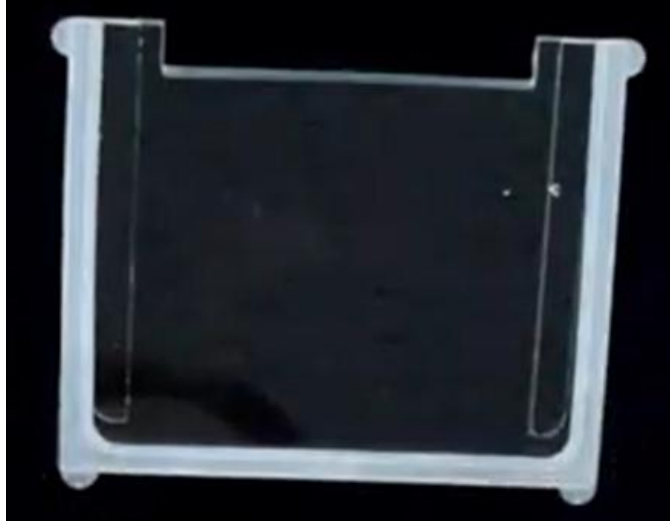
Şekil 2.2: Su sızdırmaz conta ile camın ve çentikli camın ayrılması (SDS-PAGE gel casting, 2016)
