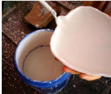
Grnt 25: Sırsız Yerlerin Fıra İle Sırlanması (Megep.2007)
