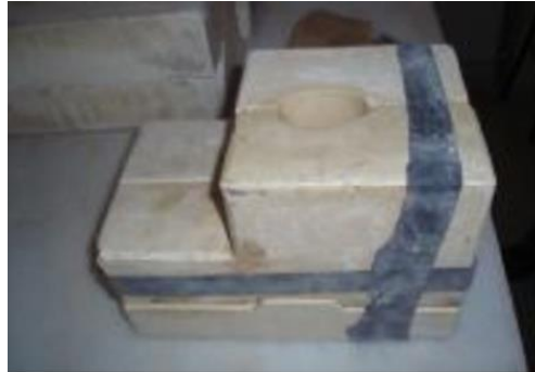
Görüntü 21: Döküm Yapılacak Kalıp Parçalarının Lastik Bantlarla Sıkıştırılması
