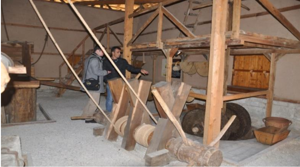
Şekil 2.5.1.1: Çift sarmallı bocurgat sistem (Evren A. arşiv). Bu sistemle zembilin üzerindeki taşı yukarı kaldırıp indirerek zeytinin ezilmesi sağlanıyor.
