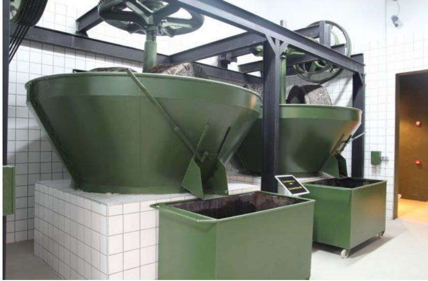
Şekil 4.1.4: Elektrikli dönem zeytin yumuşatma tekneleri. Oleatrium, İzmir (Evren A. arşiv, 9.6.2013)
