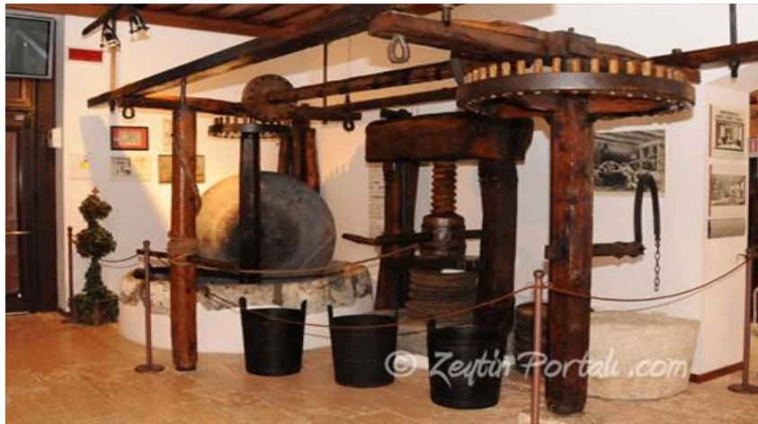
Şekil 4.2.1: Museo dell'Olio sergi alanında zeytin ezme taşı, sonsuz vidalı pres ve çark sisteminin bütün halinde bir görünüşü. (www.zeytinportali.com Museo dell'Olio) (15.3.2013)
