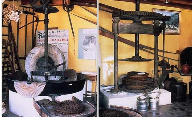
Şekil 4.4.1: 1. Zeytin yumuşatma teknesi 2. Pres (baskı aleti) ( http://www.guideweb.com/musee/olivier , 26.03.2014)
