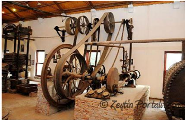
Şekil 2.6.18: Buhar gücüyle dönen makara sistemleri
