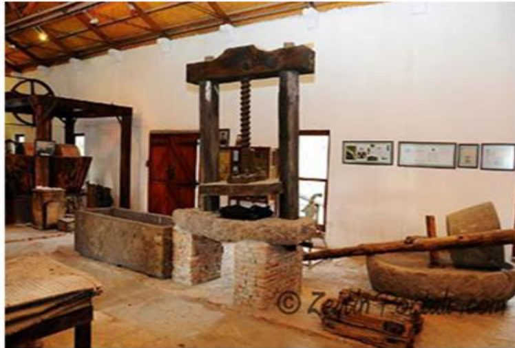
Şekil 2.6.2: Ortadaki sonsuz vidalı pres, sağda insan veya hayvan gücüyle çevrilen tekli zeytin ezme taşı
