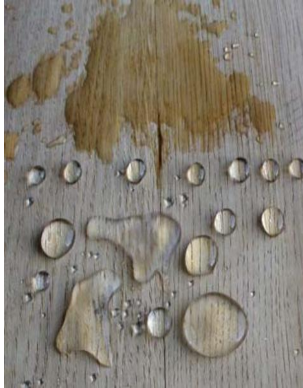
Şekil 4.4: Su geçirmezlik özellikli nano ahşap yüzey (Bardak ve diğerleri, 2006)
