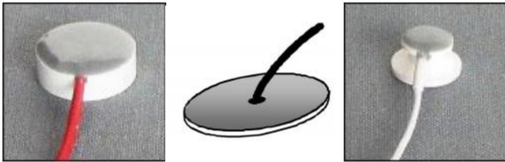
Şekil 13. Metal Plaka Elektrot
