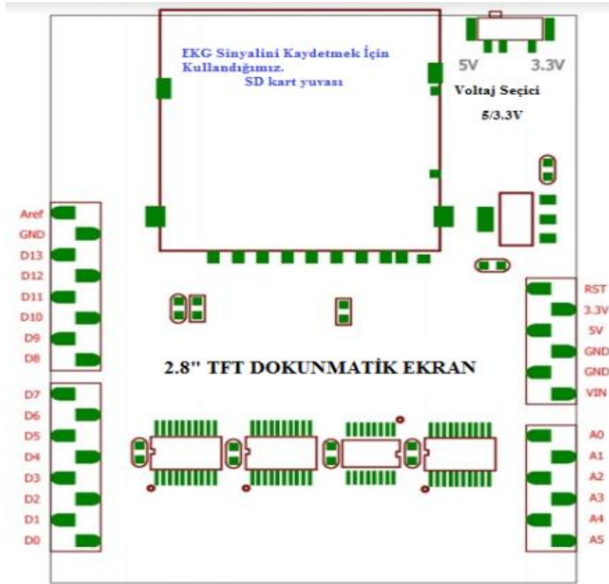
Şekil 33 2.8" Touch LCD Şeması
