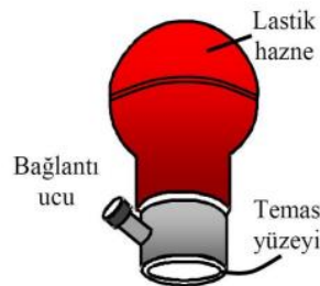
Şekil 14. Emici Düzenli Elektrot
