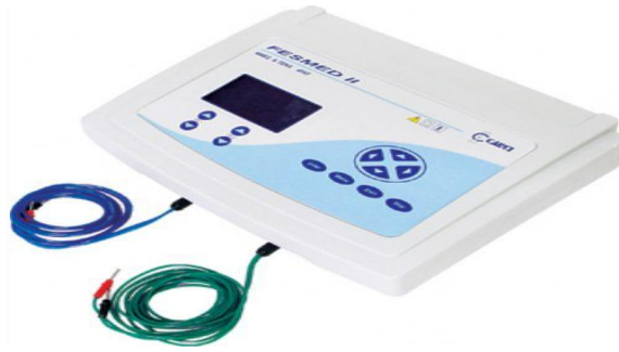
Şekil 8 Çift kanallı klinik TENS tipi cihazı
