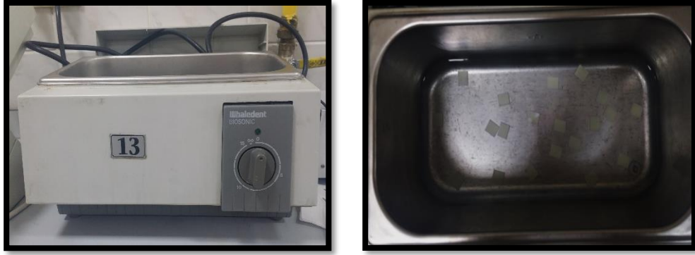
Şekil 3.11. Örneklerin ultrasonik temizleme cihazında temizlenmesi.
