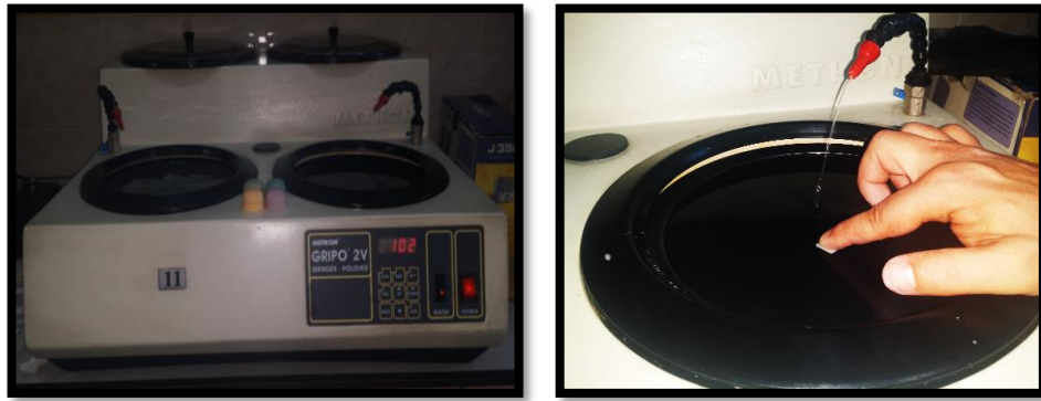
Şekil 3.10. Yüzey aşındırma ve parlatma cihazı kullanılarak örneklerin parlatılması.
