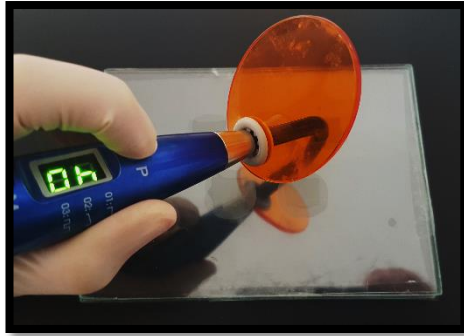
Şekil 3.21. LED ışık cihazı ile örneklerin dijital ışıkla polimerize edilmesi.
