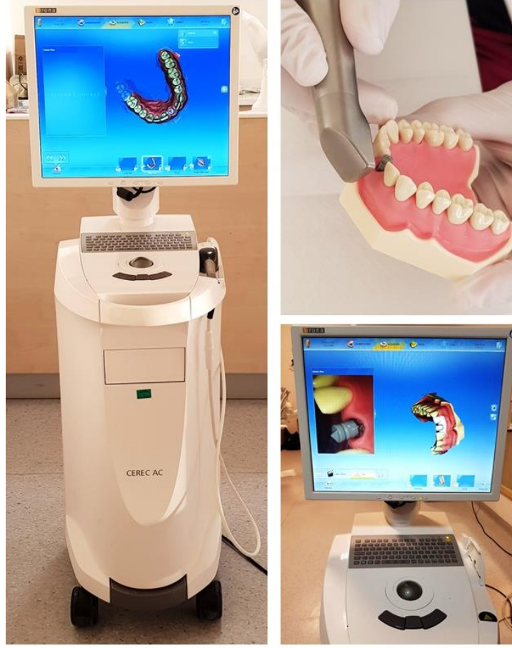
Şekil 3.11. İntraoral tarayıcı ile tarama gövdesinin taranması.
