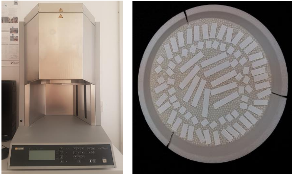
Şekil 3.9. Çalışmada kullanılan sinterleme fırını ve sinterlenen örnekler
