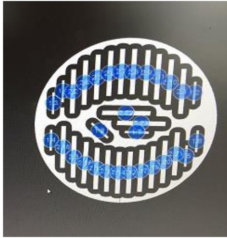
Şekil 3.4. Örneklerin CAD programı kullanılarak yarı sinterlenmiş zirkonya bloklar üzerinde konumlarının belirlenmesi
