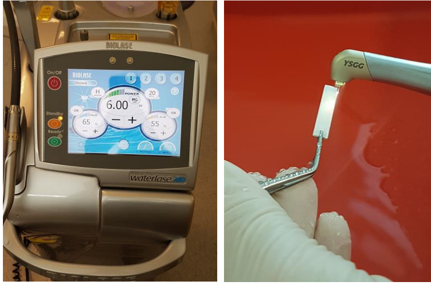
Şekil 3.11. Çalışmada kullanılan Er, Cr:YSGG lazer cihazı ve örneklerin yüzeylerine lazer uygulanması
