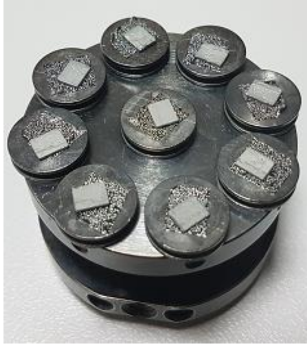
Şekil 3.17. İnceleme öncesinde platin/paladyum ile kaplanmış zirkonya örnekler
