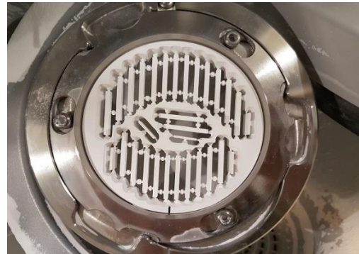
Şekil 3.5. Örneklerin CAM ünitesi ile frezelenmesi ve frezeleme işlemi sonrası örneklerin görüntüsü
