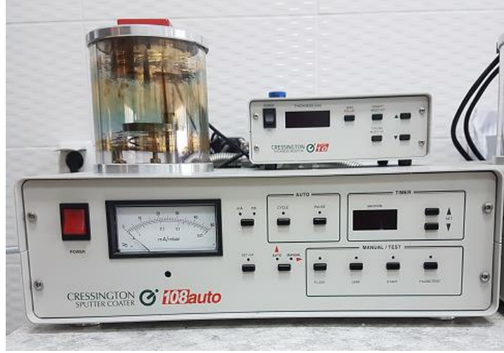
Şekil 3.11. Taramalı elektron mikroskobunda incelenecek örneklerin havasız ortamda altın ile kaplanması
