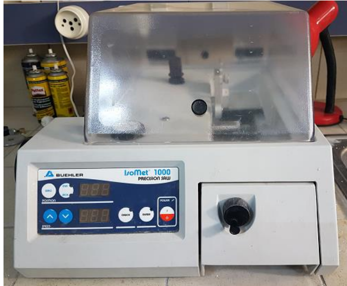
Şekil 3.6. Çalışmada kullanılan hassas mikro kesme cihazı
