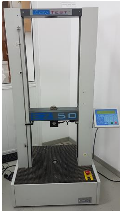
Şekil 3.7. İtme testinin uygulandığı Universal test cihazı
