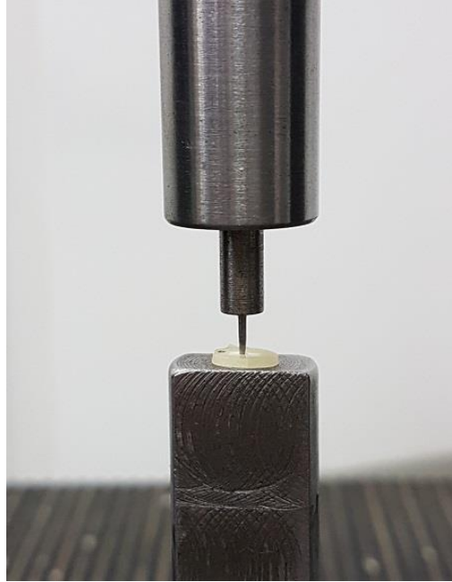
Şekil 3.9. İtme testinin hazırlanan disk örneklerine uygulanması
