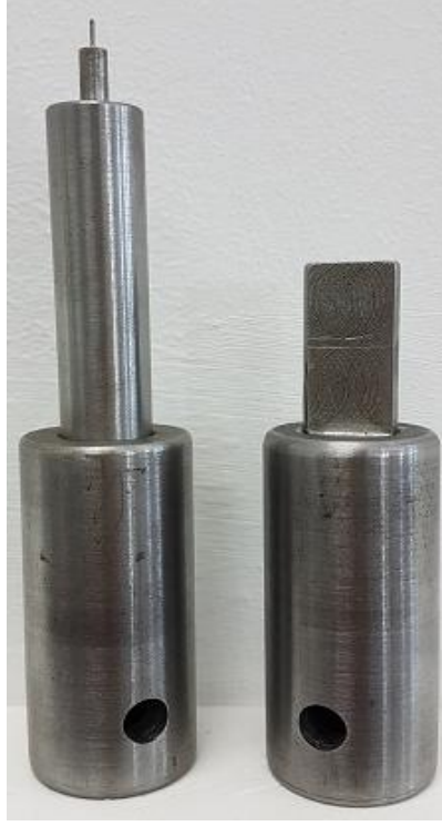
Şekil 3.8. İtme testi için özel olarak hazırlanan bağlantı parçaları
