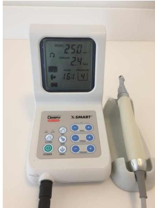
Şekil 3.3: Kanal Enstrümantasyonunda Kullanılan X-Smart Plus Endo-Motor Cihazı
