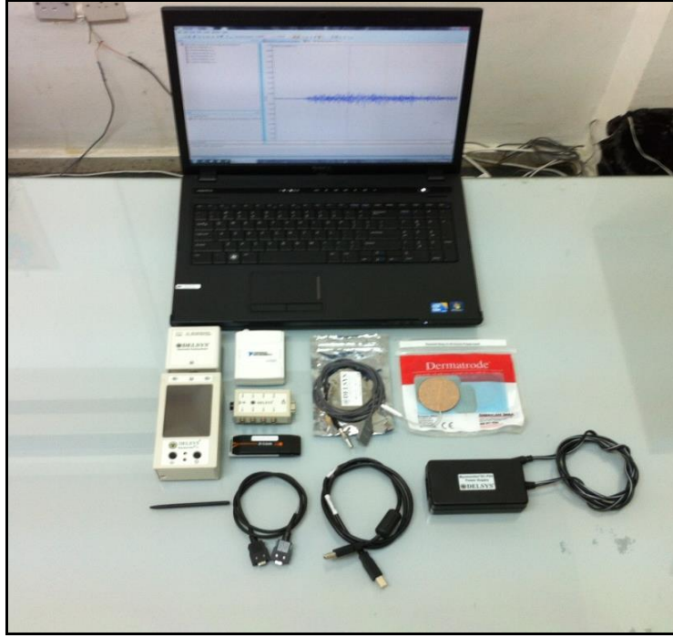
Şekil 3.1: Deney düzeneğinde kullanılan EMG cihaz ve analiz sistemi.
