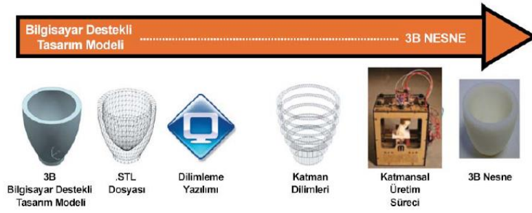
Şekil 2.4. Katmanlı üretim (üç boyutlu baskı) süreci (Campbell, Williams, Ivanova, ve Garrett, 2011)
