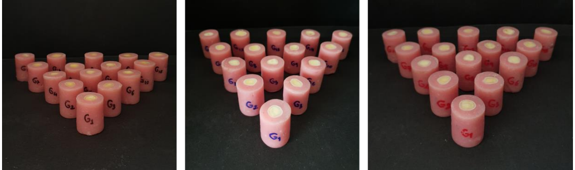
Resim 10. CG, G6.5 ve G12.5 gruplarında kullanılan dişlerin gömülü olduğu akrilik bloklar.
