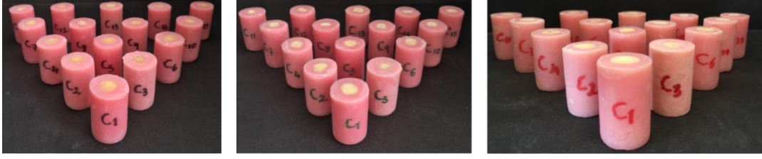
Resim 8. CC, C6.5 ve C12.5 gruplarında kullanılan dişlerin gömülü olduğu akrilik bloklar.
