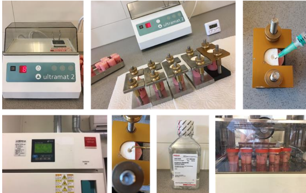
Resim 14. Çalışmada kullanılan Ceramir C&B simanın uygulanış şekli.
