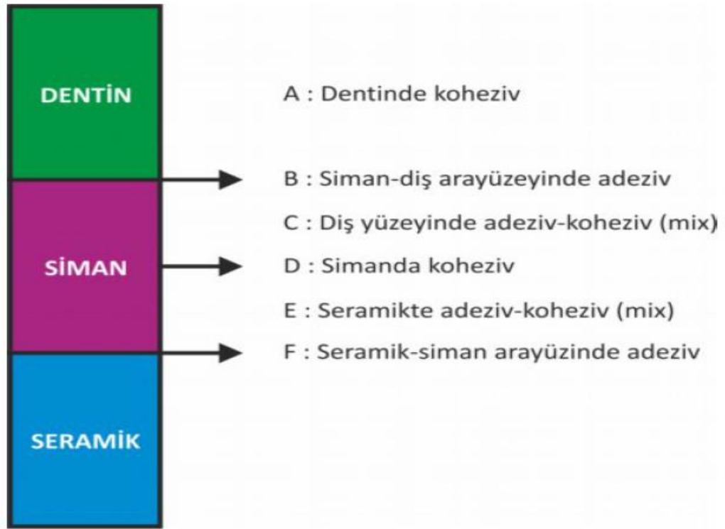
Şekil 8. Kırık yüzey analiz sınıflamasının şematik gösterimi.
