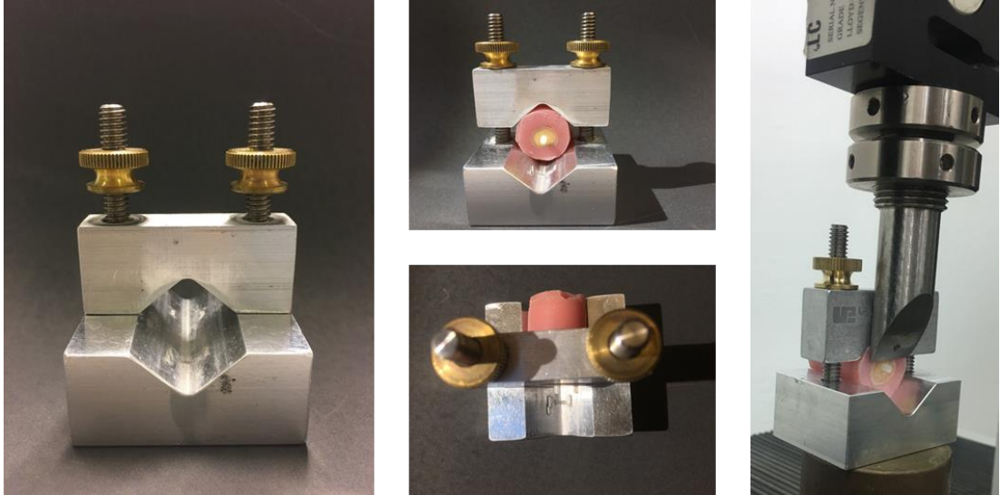
Resim 15. Makaslama bağlanma direnci testi düzeneği.
