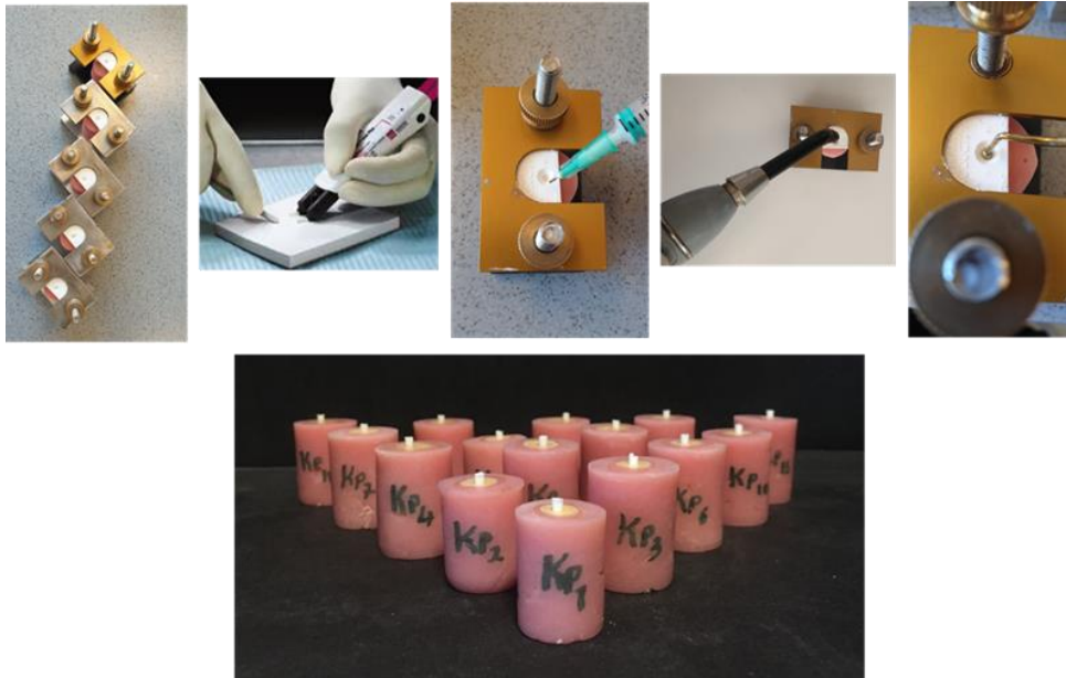
Resim 12. Çalışmada kullanılan Ketac Cem Plus simanın uygulanış şekli.
