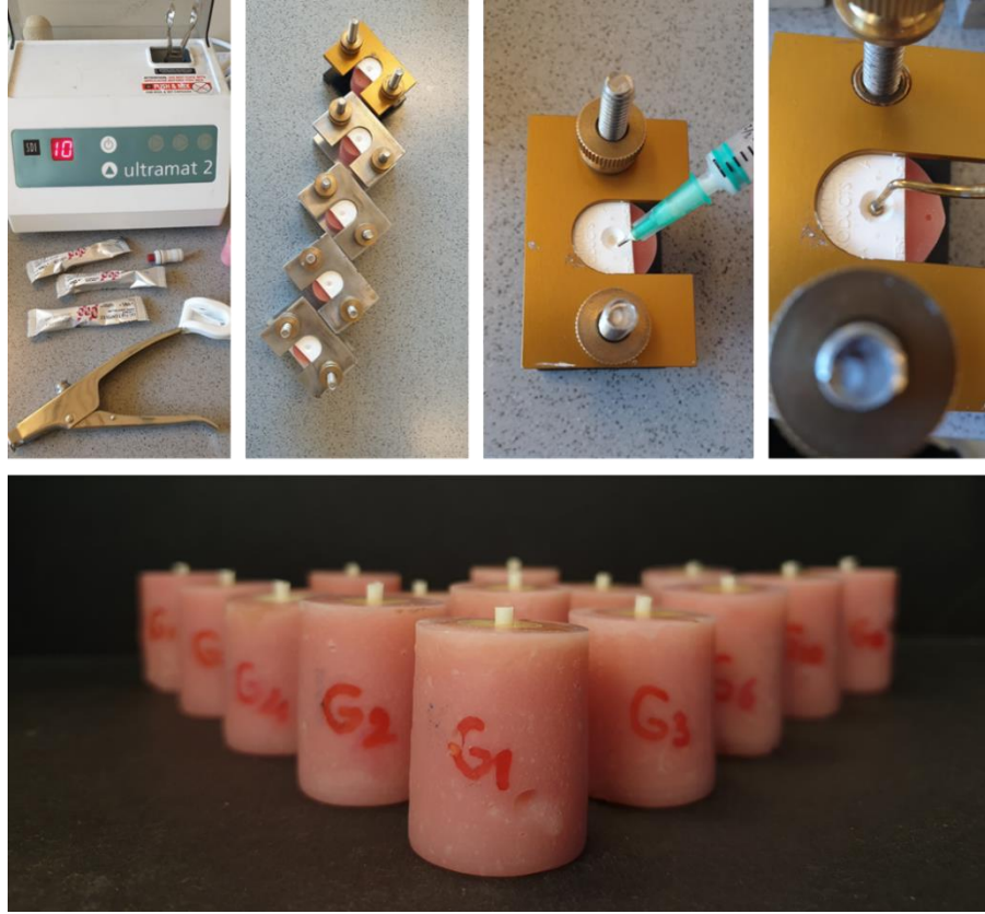
Resim 13. Çalışmada kullanılan GC Fuji1 Kapsül simanın uygulanış şekli.
