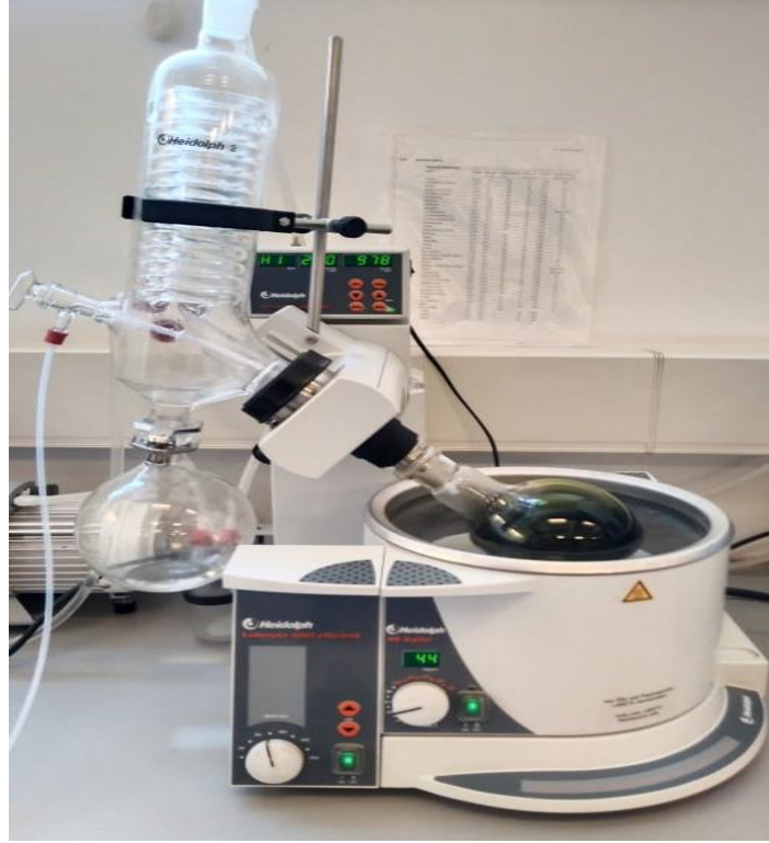
Şekil 3.5. Rotary evaporatörde uçurulan CO.
