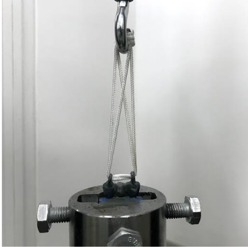
Şekil 3.7: Gerilim bağlanma dayanımı test düzeneği
