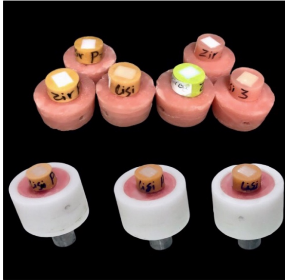
Resim 12: Seramik Örneklerin Çiğneme Simülatörü İçin Hazırlanması.
