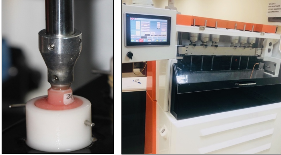
Resim 14: (A) Örneklerin çiğneme simülatöründe yorulma aşaması (B) Çiğneme simülatörünün 50 N yükleme aşaması.
