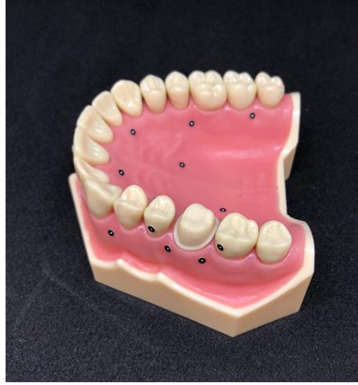
Resim 28: Atos Core 80 referans tarayıcısı ile taranacak olan modele yerleştirilen referans noktaları.
