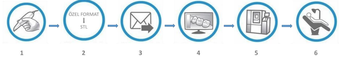
Şekil 13: Açık sistemlerdeki iş akışı. 1- İntraoral tarama verisinin elde edilmesi. 2- Elde edilen tarama verisinin özel formattan STL formatına dönüştürülmesi. 3- STL formatındaki tarama verisinin CAD yazılımına aktarılması. 4- Her tarayıcıdan veri kabul edebilen CAD yazılımında restorasyonun tasarlanması. 5- CAM işlemleri ile restorasyonun elde edilmesi. 6- Restorasyonun hastaya teslim edilmesi.
