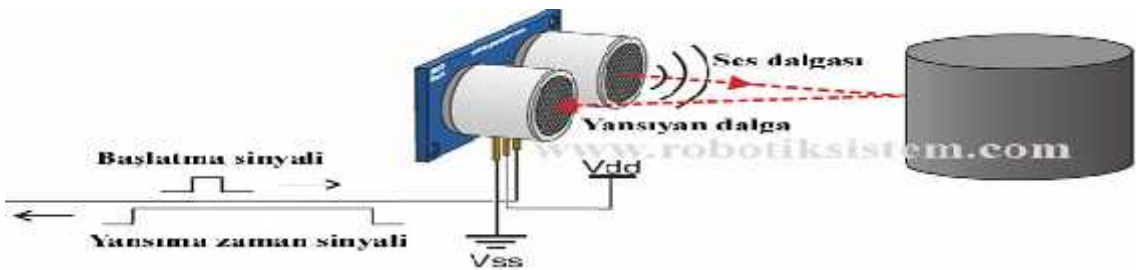
ekil.8. Ultrasonik mesafe sensörünün çalışma prensibi
