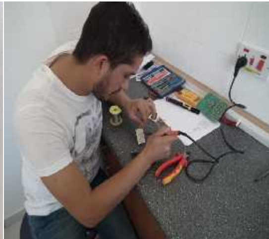
ekil.15.Baskı devrelerin bakır plaket üzerine uygulanması ve hazırlanması
