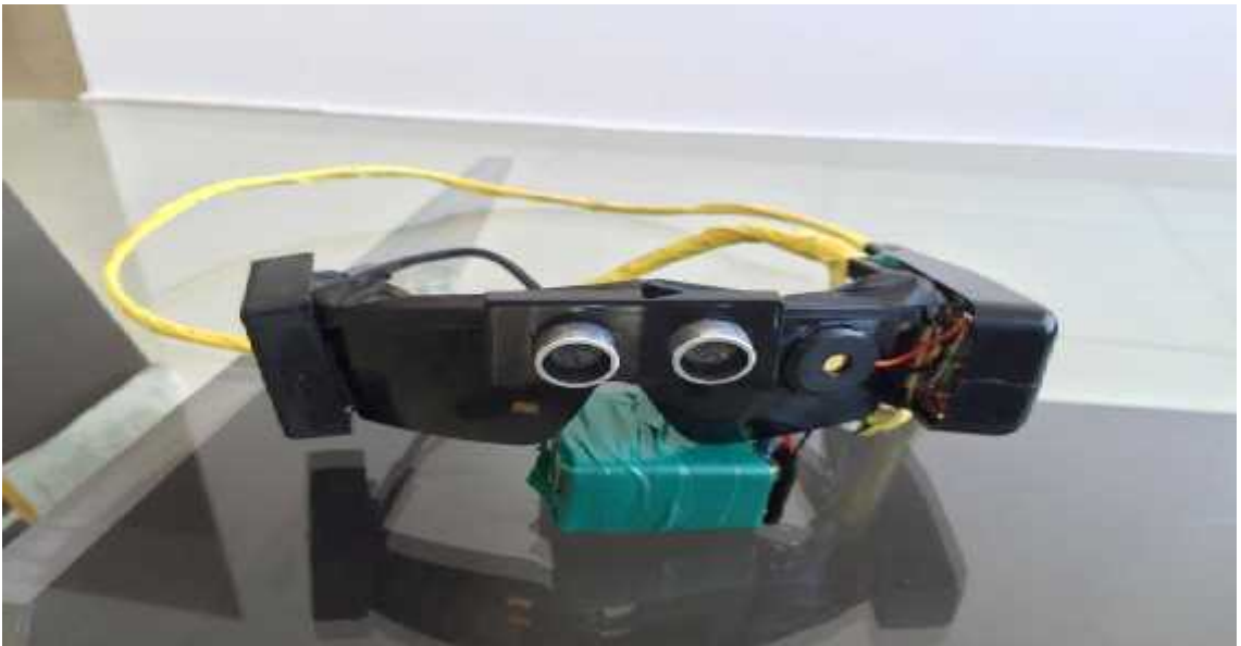
ekil.17.Devrelerin gözlük üzerine entegre edilmesi ve gözlü ün son ekli
