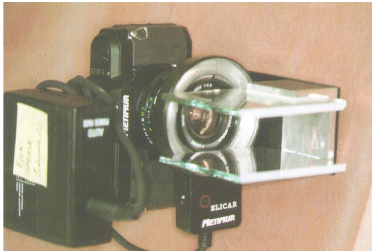
Resim 2.9. Reflektif aynalar sabitlendiği fotogrametrik kamera (Lie ve Jemt, 1994).
