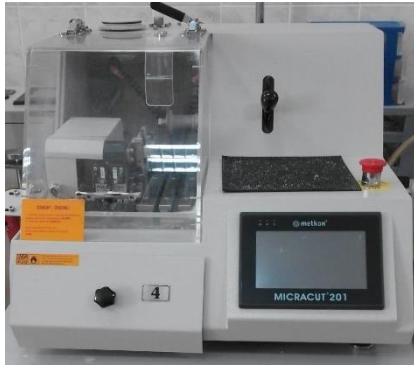
Resim 3.1. 1mm kalınlığında dentin örneklerin elde edildiği 'Micro-cut' cihazı.
