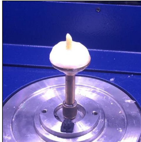
Resim 21. Numunelerin 5 dakikalık entegrasyon süresi içinde 360° döndürülmesi işlemi.
