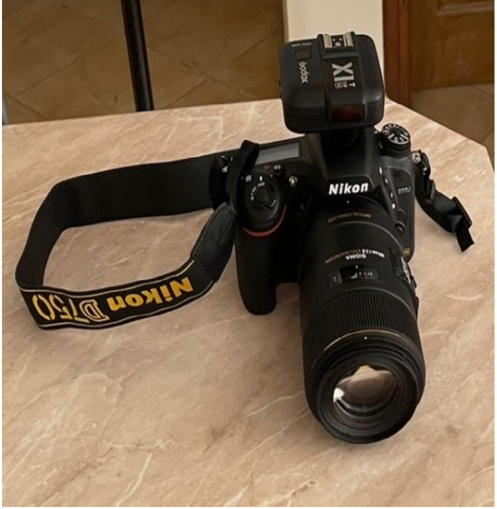
Resim 9. Makro lensli yüksek çözünürlüklü bir kamera (Nikon D750, Nikon 105 mm Makro Lens)
