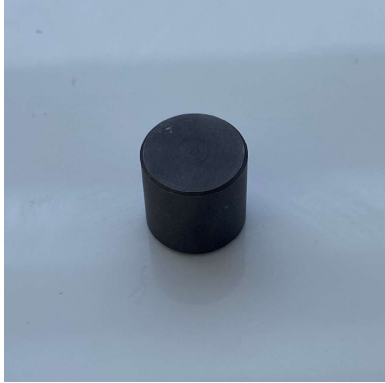
Resim 4. İmplant yüzeyini taklit eden diskin diagonal görüntüsü
