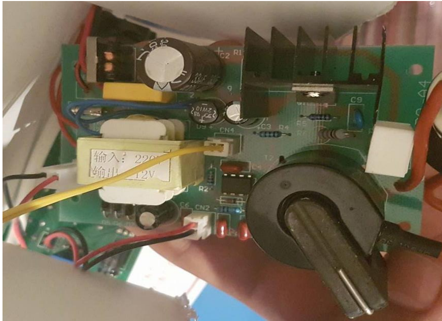
Şekil 2.3.4:220AC Gerilimi 12AC Gerilime Çeviren Özel Bir Trafo Kullanılır.
