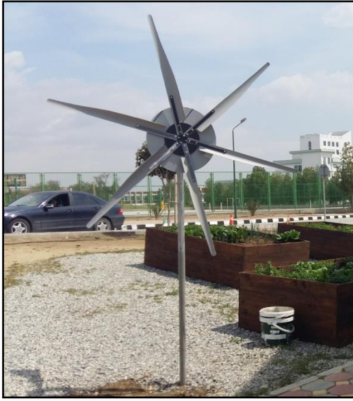
(a) Atık malzemelerden yapılan rüzgar türbini
