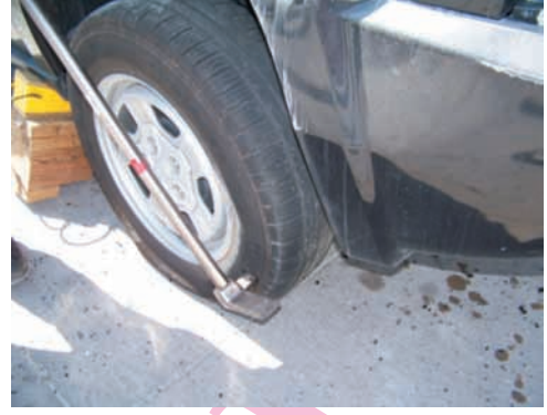
Şekil 4 • Önceden kızaklanmış aracın lastiklerinin patlatılması
