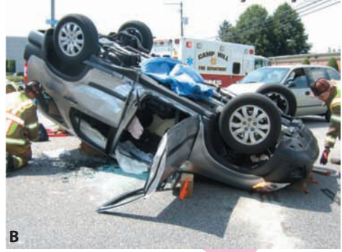
Şekil 6 • A. Ters dönen aracın takoz ve gergi direkleri ile sabitlenmesi. B. Ters dönen aracın takoz ve gergi direkleri ile sabitlenmesi.
