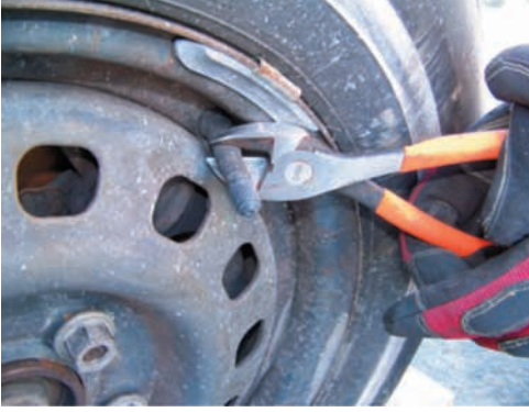
Şekil 3 • Lastik siboplarının kesilmesi.
