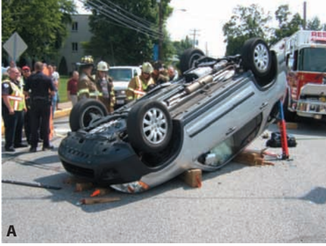
Şekil 6 • A. Ters dönen aracın takoz ve gergi direkleri ile sabitlenmesi. B. Ters dönen aracın takoz ve gergi direkleri ile sabitlenmesi.
