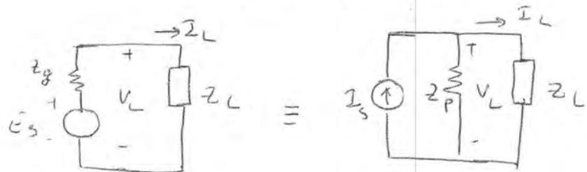
$$V_L = E_g - Z_g I_L \quad = \quad V_L = (I_s - I_L) Z_p \\ = Z_p I_s - Z_p I_L$$
